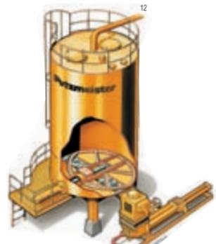
Silo di stoccaggio con scarico diretto nella pompa
