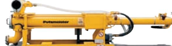
La serie KOV è caratterizzata dal suo design lineare e per la grande affidabilità. I cilindri di aspirazione e di mandata sono connessi da un sistema di valvole a sfera indipendenti.
