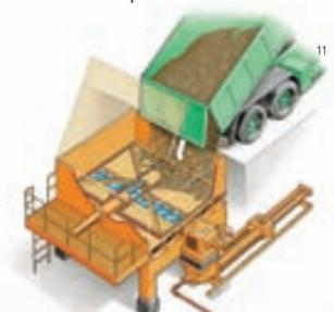
Silo di ricevimento fanghi che scarica direttamente in una pompa
